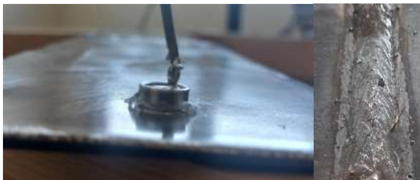
شکل ۲. صفحه‌ی مورد آزمایش و نحوه نصب حسگر.
