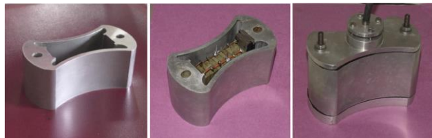
شکل 6. نمونه‌ای مبدل کششی-خمشی کلاس IV با پوسته بیضوی شکل مقعر
