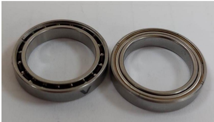
شکل ۳- بلبرینگ های استفاده شده در مکانیزم تست
