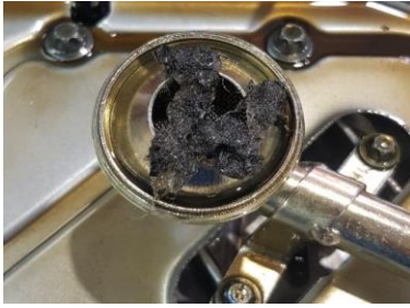
شکل ۴: لوله مکش روغن دارای گرفتگی پس از تخلیه.
