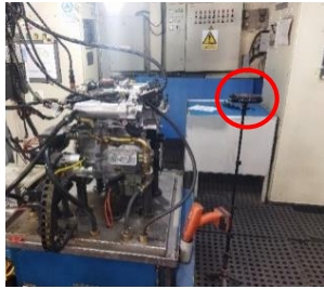
شکل ۶: نحوه اندازه‌گیری صدای موتور در مرحله تست گرم (موقعیت دوم).
