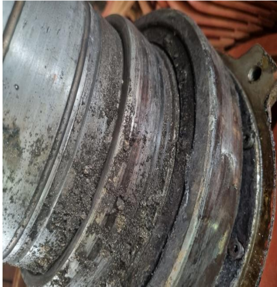
شکل ۵: استفاده از گریس نامناسب
