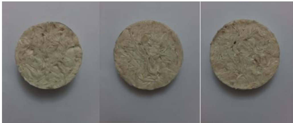
شکل ۱. نمونه های پلاستر قالب گیری شده حاوی طول های مختلف از الیاف استبرق؛ از سمت چپ به ترتیب با ضخامت ۵/۰، ۱ و ۲ سانت.
