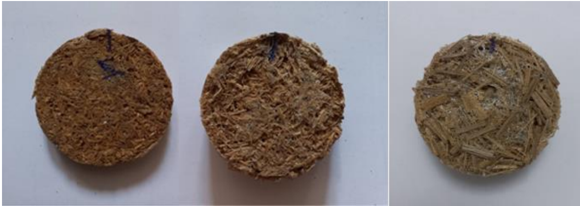
شکل ۱ نمونه‌های پلاستر قالب‌گیری شده حاوی طول‌های مختلف از الیاف گیاهی تیفا؛ از سمت چپ به ترتیب با طول ۰/۵، ۱ و ۲ سانت.
