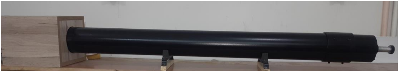
شکل ۳ لوله امپدانس با روش نسبت موج ایستا با مدل 9410 ساخته شرکت آوا سینا
